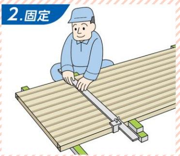
切断したい位置にガイドを合わせ、固定金具でフェンスとガイドを固定。
