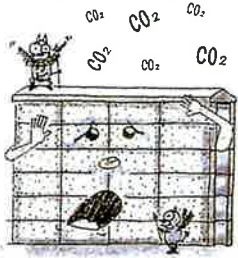
①炭酸ガスによるモルタルの中性化(注6)
